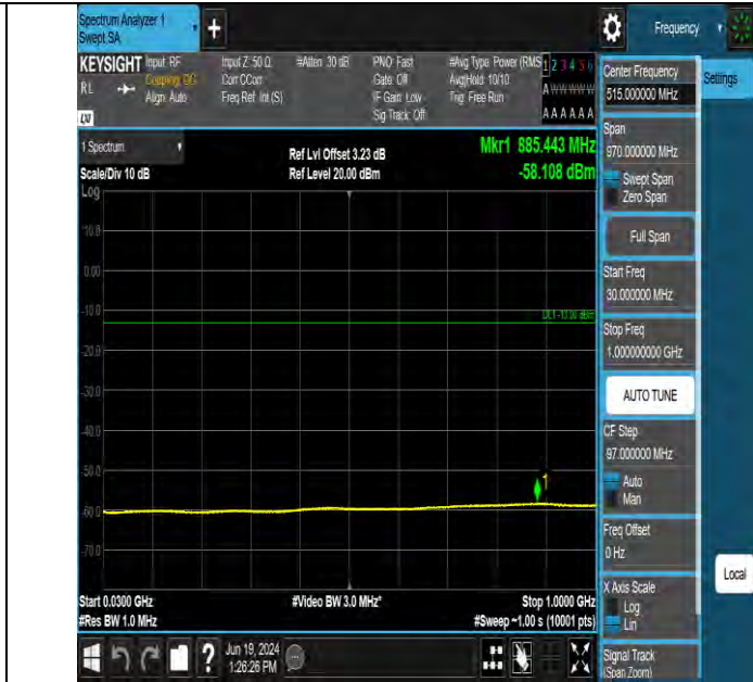
Band2 20MHz QPSK 18700 1RB#0 30~100 30~100
