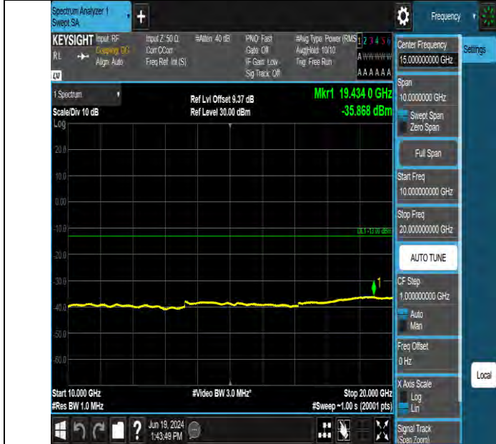
Band2 10MHz QPSK 19150 1RB#49 10000~20000 10000~20000
