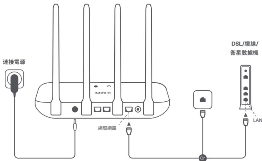
**開啟路由器電源，然後將網際網路 (WAN) 連接埠連接至 DSL/ 纜線/衛星數據機**
