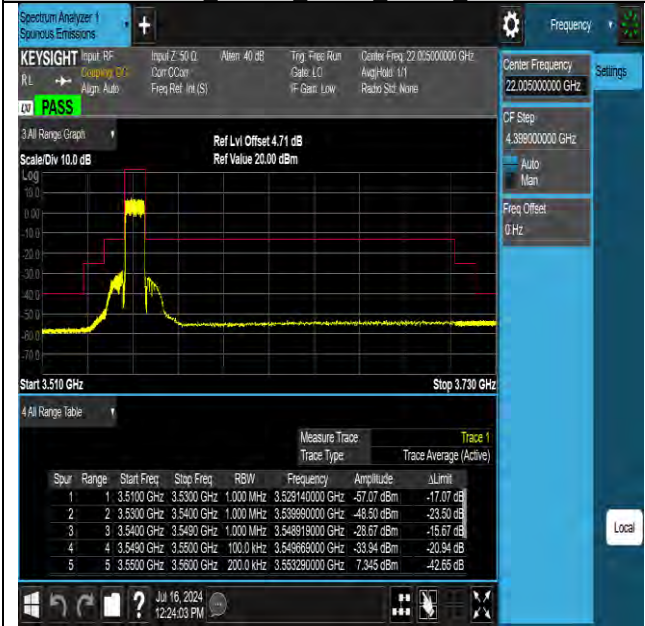
Band48 10MHz QPSK 55290 50RB#0
