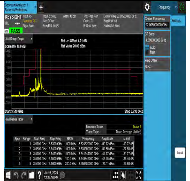
Band48 10MHz QPSK 55290 1RB#49
