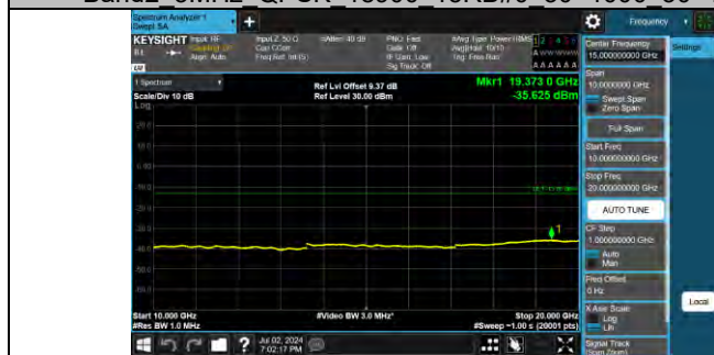
Band2 3MHz QPSK 18900 15RB#0 10000~20000 10000~20000
