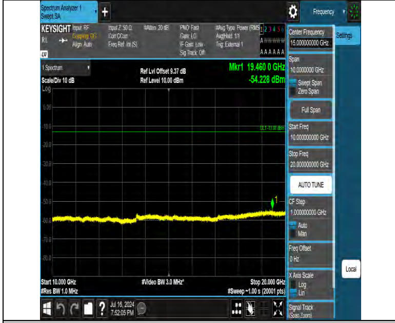
Band42 20MHz QPSK 42590 1RB#0 10000~20000 10000~20000
