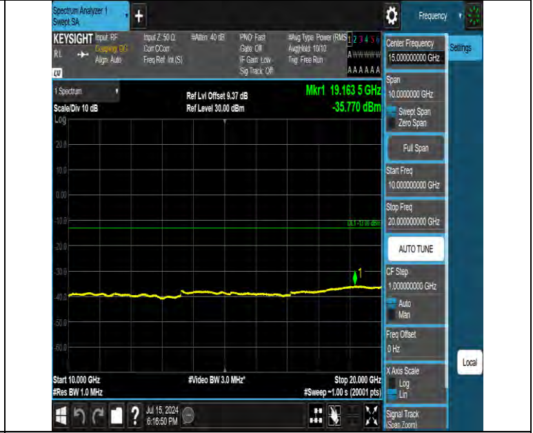
Band66 3MHz QPSK 131987 1RB#0 10000~20000 10000~20000
