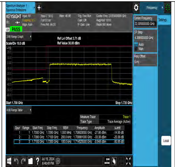
Band66 20MHz QPSK 132072 100RB#0
