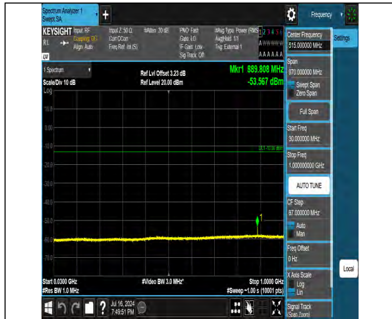
Band42 20MHz QPSK 42190 1RB#0 30~1000 30~1000
