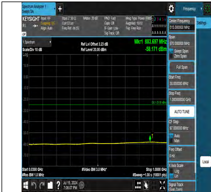
Band7 10MHz QPSK 21100 1RB#0 30~1000 30~1000
