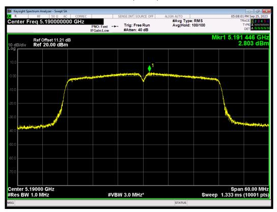
PSD 802.11ac(VHT40) 5230MHz
