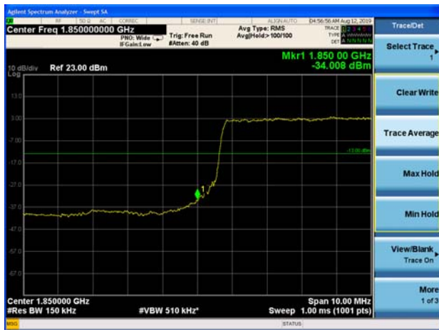
LTE Band 2 20MHz QPSK 1RB CH-Low
