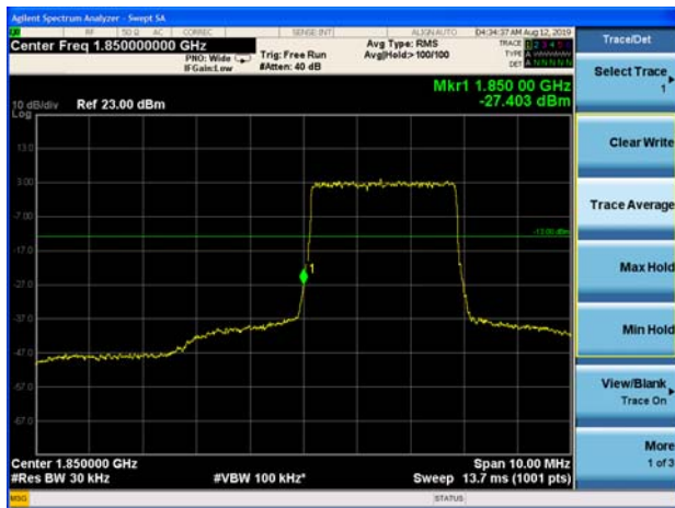
LTE Band 2 5MHz QPSK 1RB CH-Low
