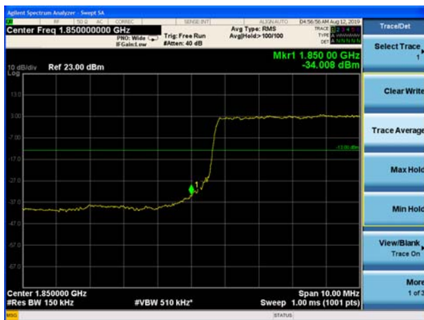
LTE Band 2 20MHz QPSK 1RB CH-Low
