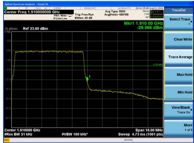
LTE Band 2 10MHz QPSK 1RB CH-High
