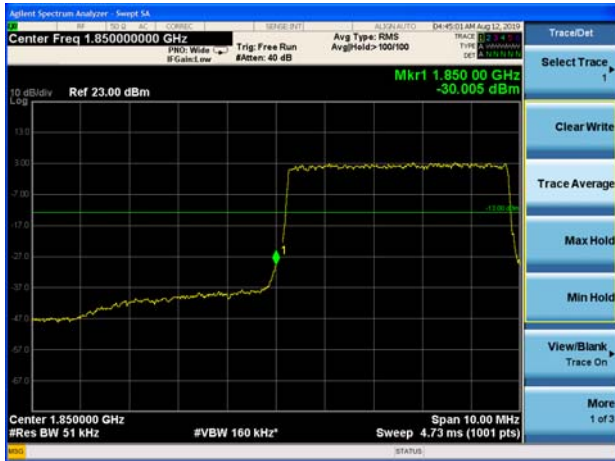
LTE Band 2 10MHz QPSK 1RB CH-Low
