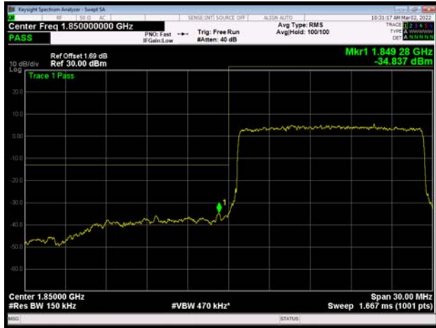
LTE Band 2 20MHz QPSK 1RB CH-Low
