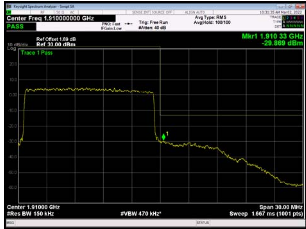
LTE Band 2 20MHz QPSK 1RB CH-High
