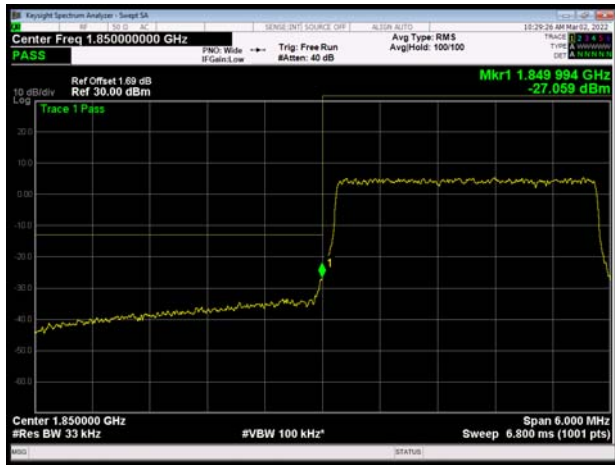
LTE Band 2 5MHz QPSK 1RB CH-Low
