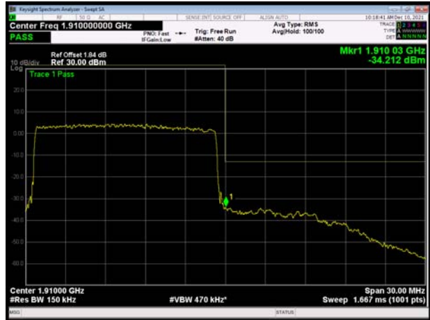
LTE Band 2 20MHz QPSK 1RB CH-High
