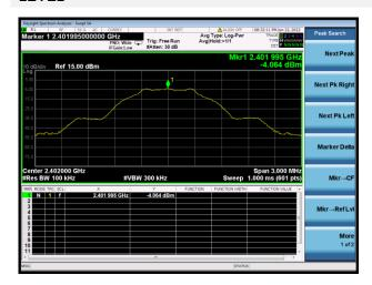
GFSK (BLE 1Mbps) LOW CHANNEL, REFERENCE LEVEL
