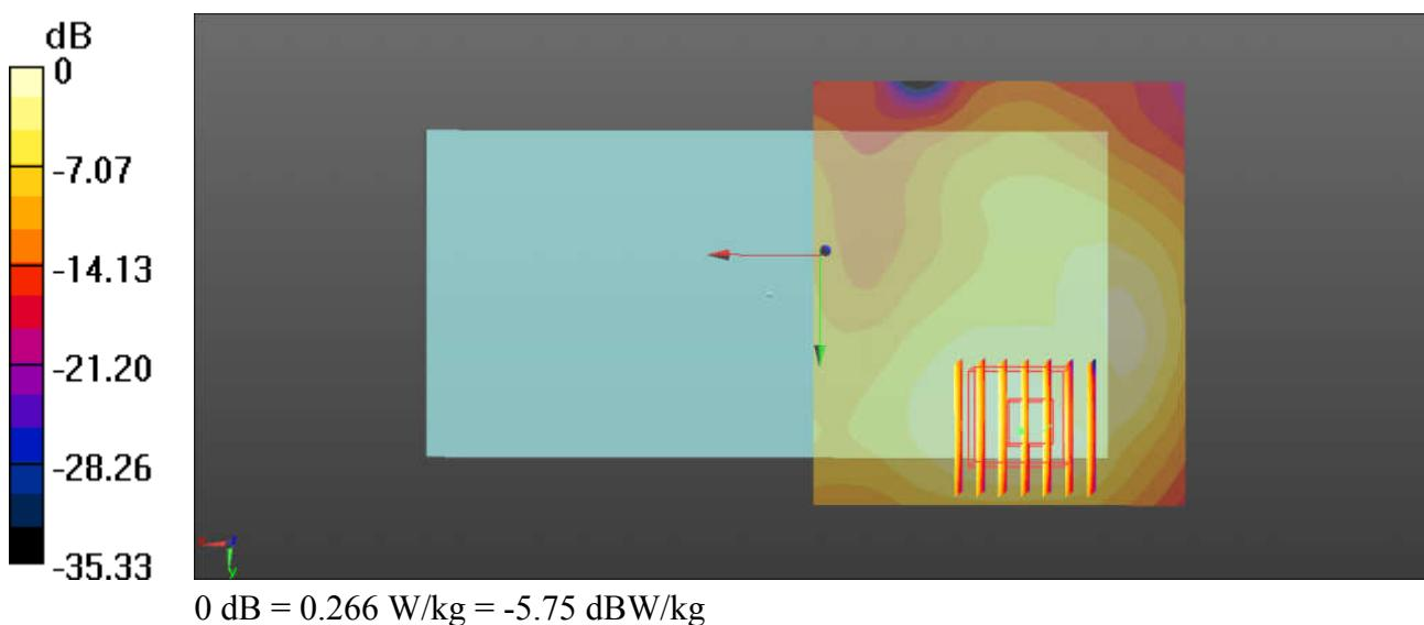
**54\_WLAN2.4GHz\_802.11b 1Mbps\_Back\_10mm\_Ant 2\_Ch1**
