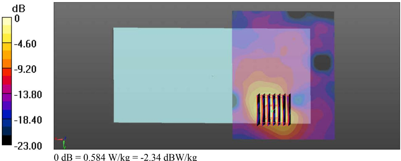
**57\_WLAN5.5GHz\_802.11a 6Mbp\_Back\_10mm\_Ant 1\_Ch100**
