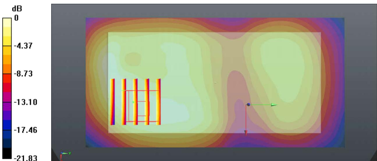
**34\_LTE Band 7\_20M\_QPSK\_1RB\_49Offset\_Back\_10mm\_Ch21350**
