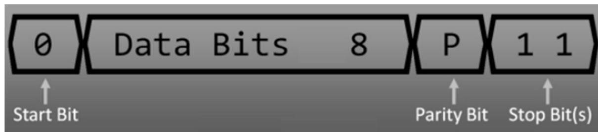
Figure10. UART Data Format
