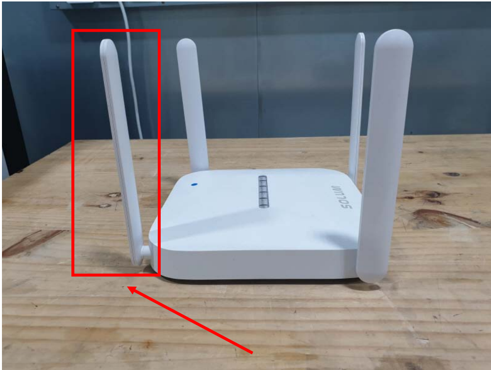
Antenna 1(TX, RX)(Freq : 2402-2480 MHz)
