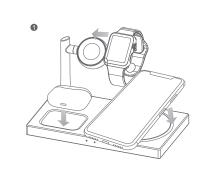
① 确认无线充电器连接电源,并处于待机状态。 ② 将智能手机/Airpods/Apple Watch发别放置在产品对应充电位置上, 指示灯蓝色长亮,,当有金属等异物放置在充电板上,指示灯呈蓝灯闪烁。
