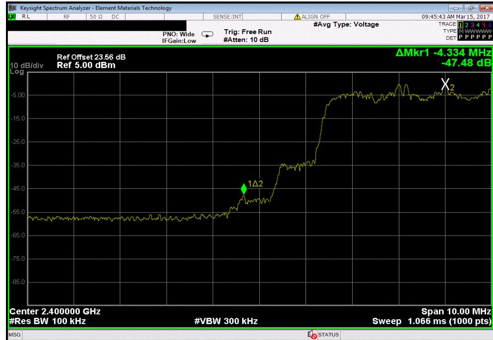
Hopping Mode, 2DH5, pi/4-DQPSK, High Channel, 2480 MHz
