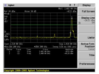
$\pi$  /4-DQPSK: Band Edge-High Channel
