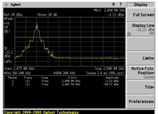
$\pi$  /4-DQPSK: Band Edge-Low Channel (Hopping Mode)
