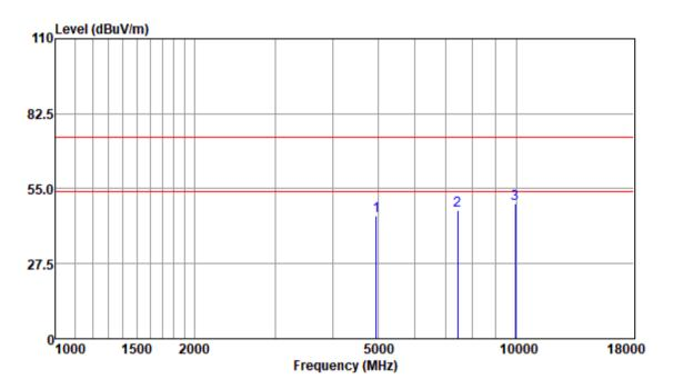
Test Mode: 00; Polarity: Horizontal; Modulation:π/4 DQPSK; Channel:High
