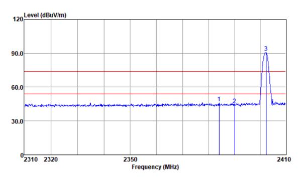
Test Mode: 00; Polarity: Horizontal; Modulation:π/4 DQPSK; Channel:Low
