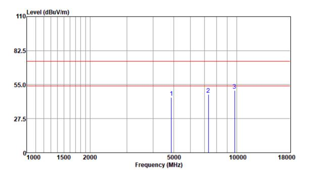
Test Mode: 00; Polarity: Horizontal; Modulation:π/4 DQPSK; Channel:middle
