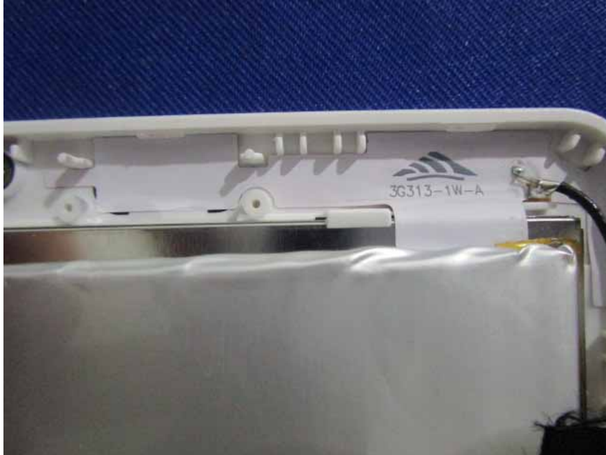
EUT -GSM/WCDMA Antenna View
