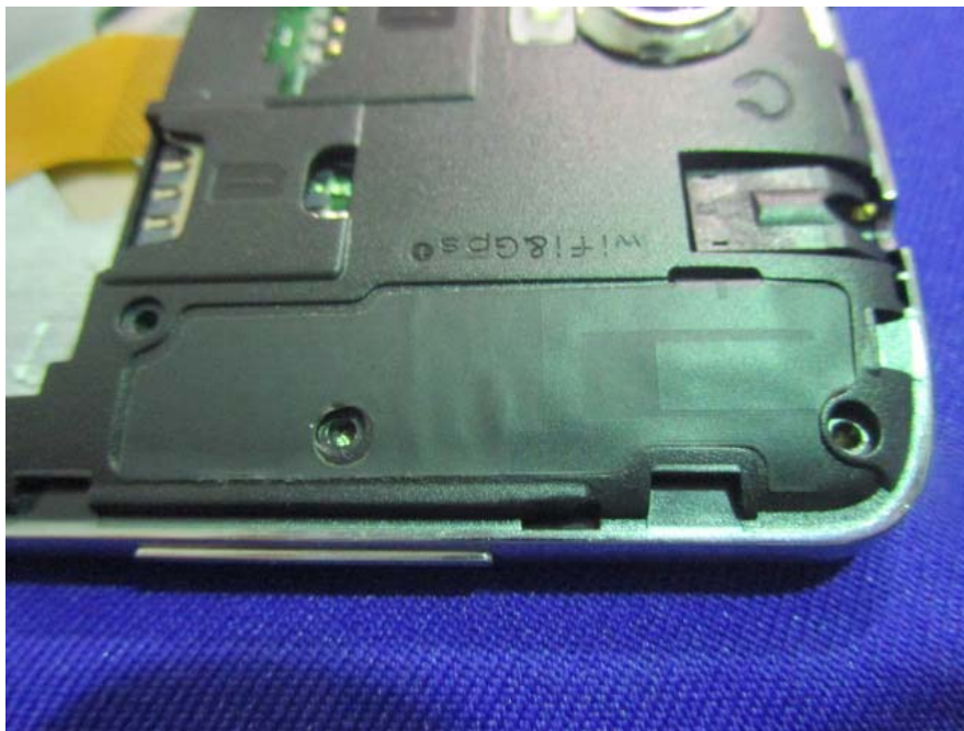
EUT –BT&WIFI&GPS Antenna View
