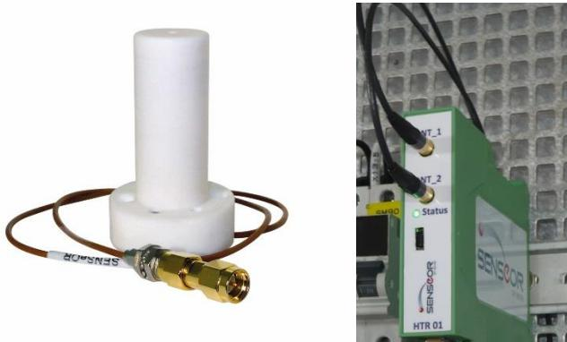
Une antenne sur "Ant\_1A" est nécessaire pour l'interrogation de six capteurs à l'air libre.
