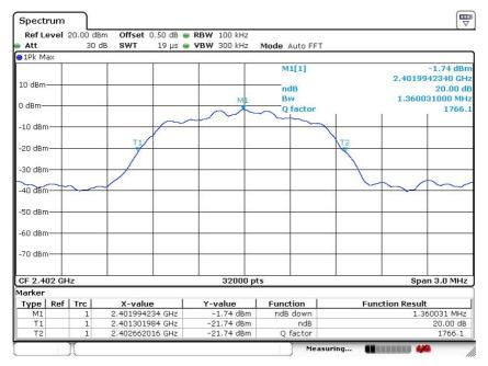
Modulation Standard:  $\pi/4$  DQPSK
