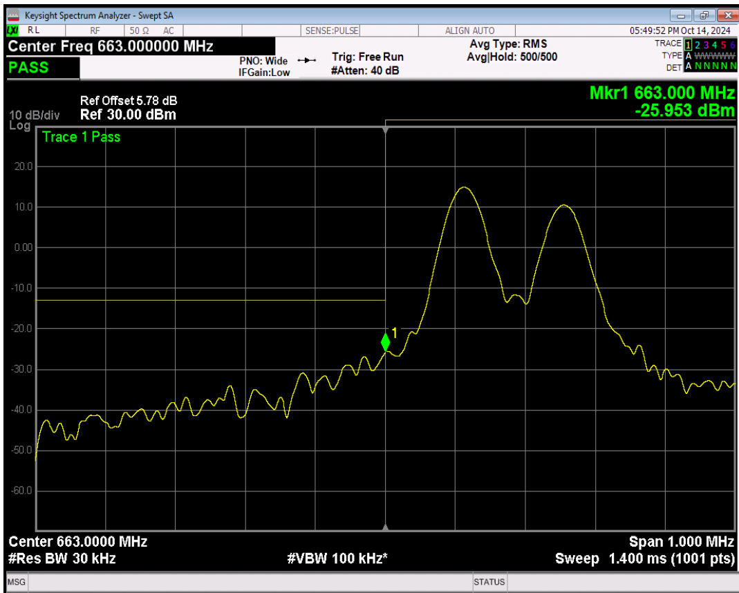
Band71 QPSK Channel=133124 nTones=1@0 Spacing=3.75kHz
