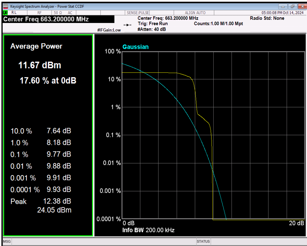
Band71 QPSK Channel=133124 nTones=1@0 Spacing=15kHz
