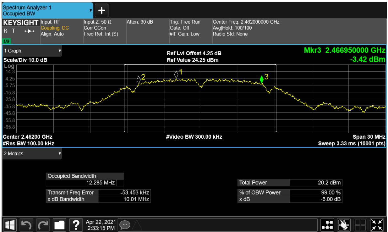
-6dB Bandwidth NVNT b 2462MHz Ant1
