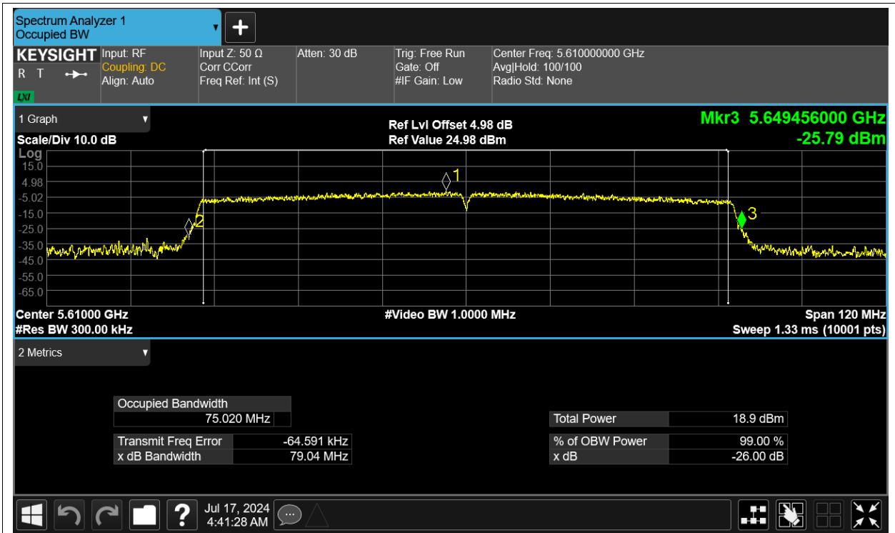
-26dB Bandwidth NVNT n20 5500MHz Ant1
