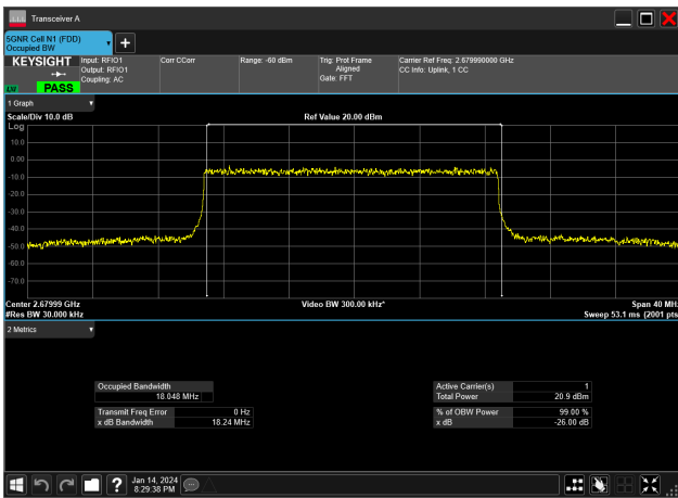
20MHz_30kHz_2679.99MHz_DFT-s-OFDM 64 QAM_RB50@0&18.048 MHz
