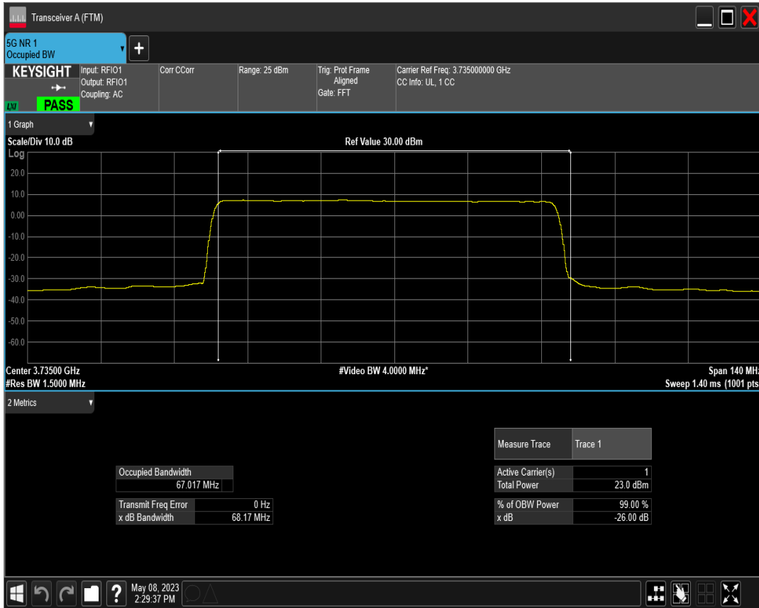
n78(3700-3800) SCS=30kHz CP_QPSK BW=70MHz Channel=649000 RB=189@0
