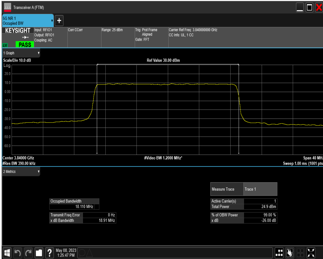
n77(3700-3980) SCS=30kHz DFT_QAM16 BW=20MHz Channel=656000 RB=50@0
