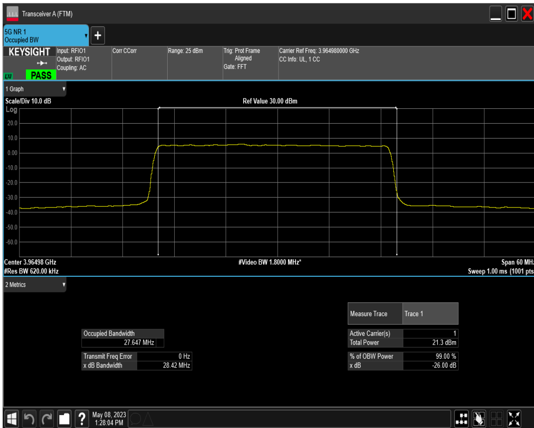
n77(3700-3980) SCS=30kHz CP_QPSK BW=30MHz Channel=664332 RB=78@0
