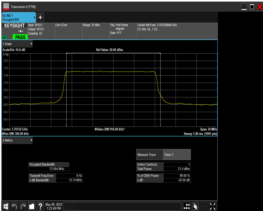
n77(3700-3980) SCS=30kHz CP_QPSK BW=15MHz Channel=647168 RB=38@0
