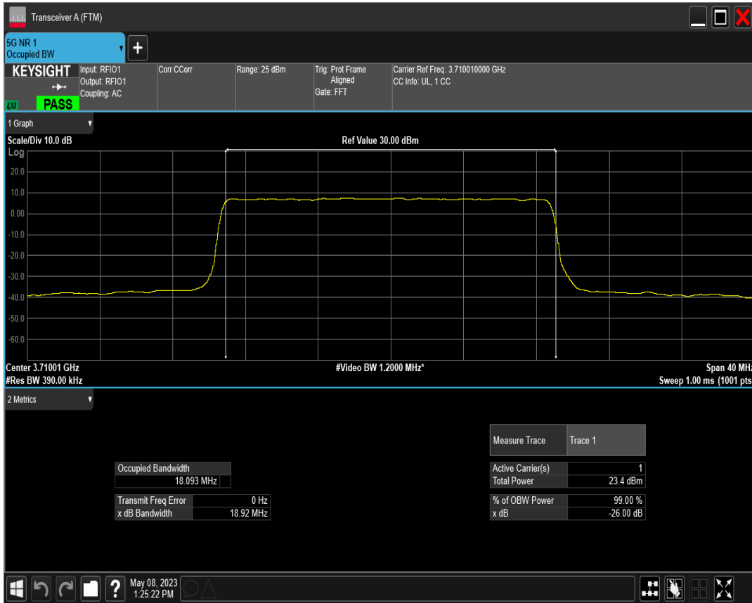
n77(3700-3980) SCS=30kHz DFT_QAM256 BW=20MHz Channel=647334 RB=50@0
