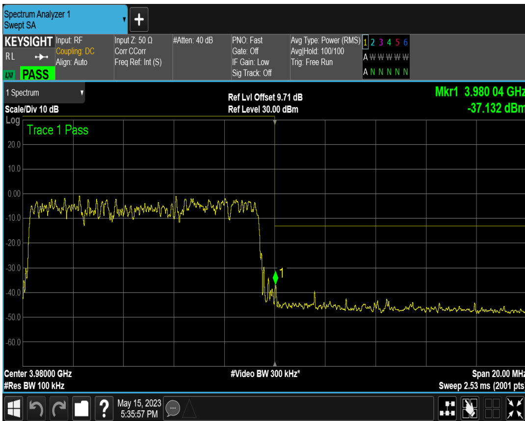
n77(3700-3980) SCS=15kHz DFT_QPSK BW=10MHz Channel=665000 RB=1@51
