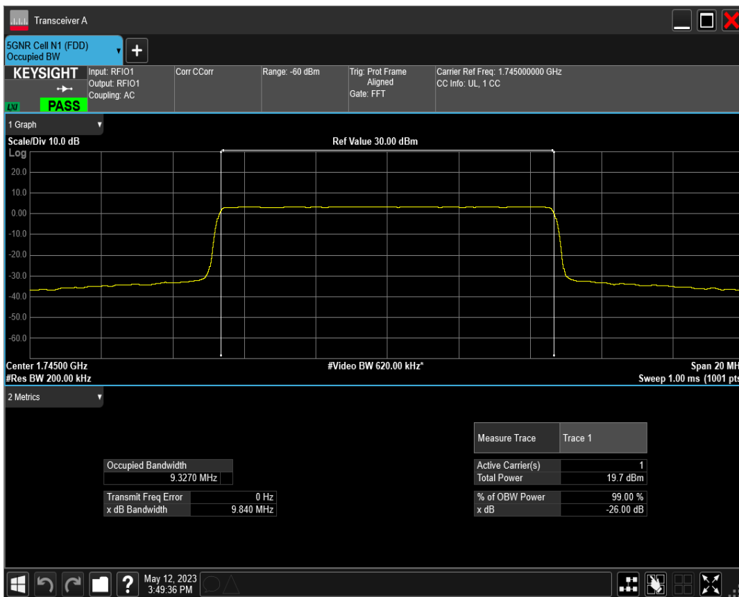
n66 SCS=15kHz DFT_BPSK BW=10MHz Channel=355000 RB=50@0
