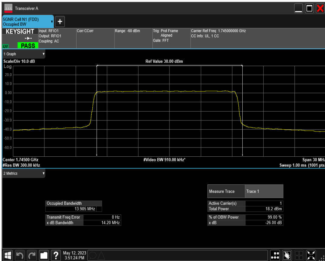
n66 SCS=15kHz CP_QPSK BW=15MHz Channel=349000 RB=79@0
