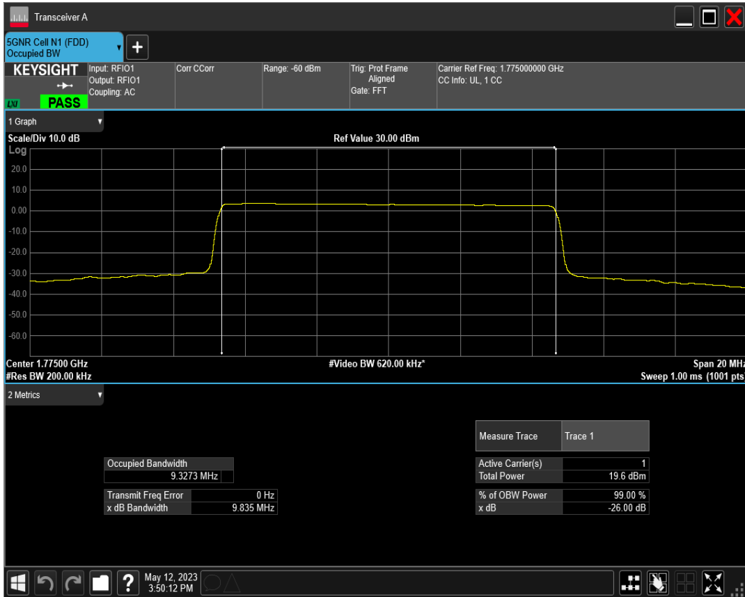
n66 SCS=15kHz DFT_BPSK BW=15MHz Channel=343500 RB=75@0
