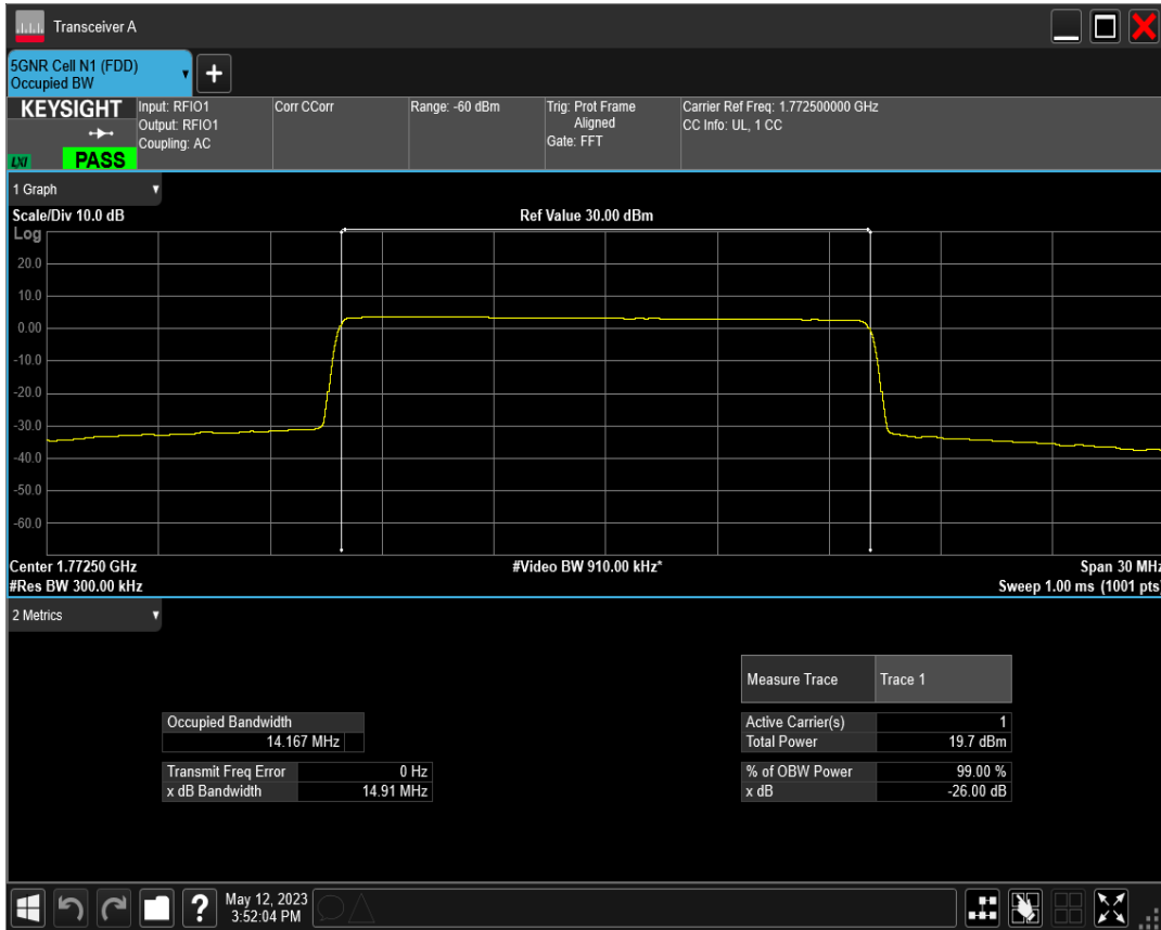
n66 SCS=15kHz DFT_BPSK BW=20MHz Channel=344000 RB=100@0
