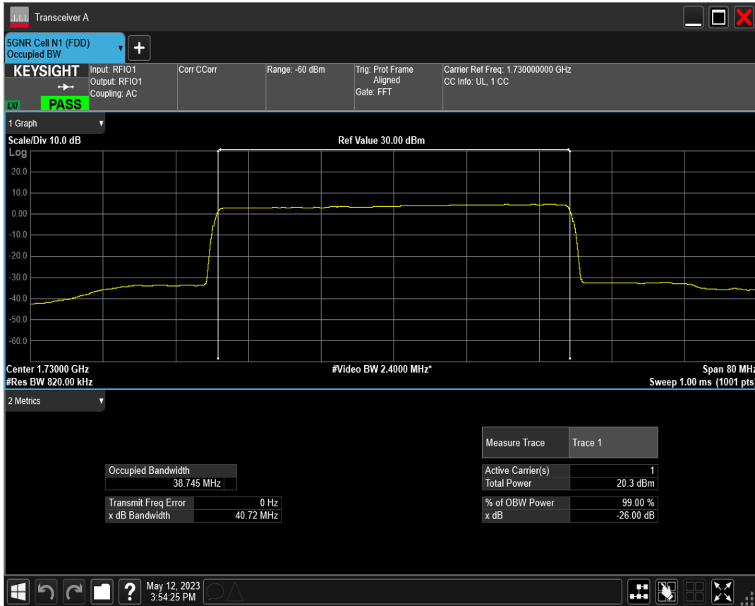
n66 SCS=15kHz DFT_QAM256 BW=40MHz Channel=346000 RB=216@0
