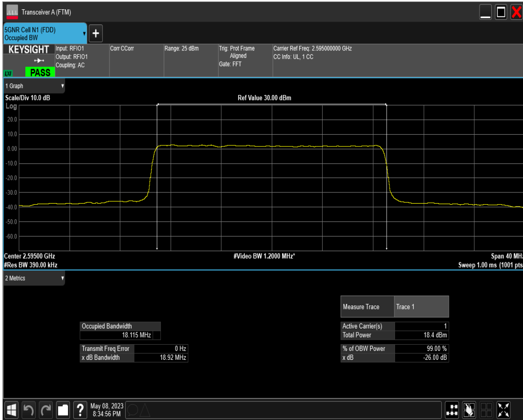
n38 SCS=30kHz CP_QPSK BW=20MHz Channel=519000 RB=51 @0
