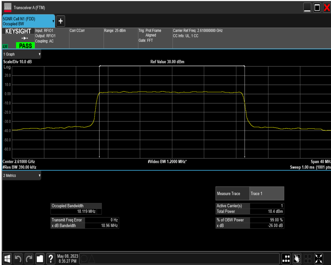
n38 SCS=30kHz CP_QPSK BW=20MHz Channel=522000 RB=51 @0
