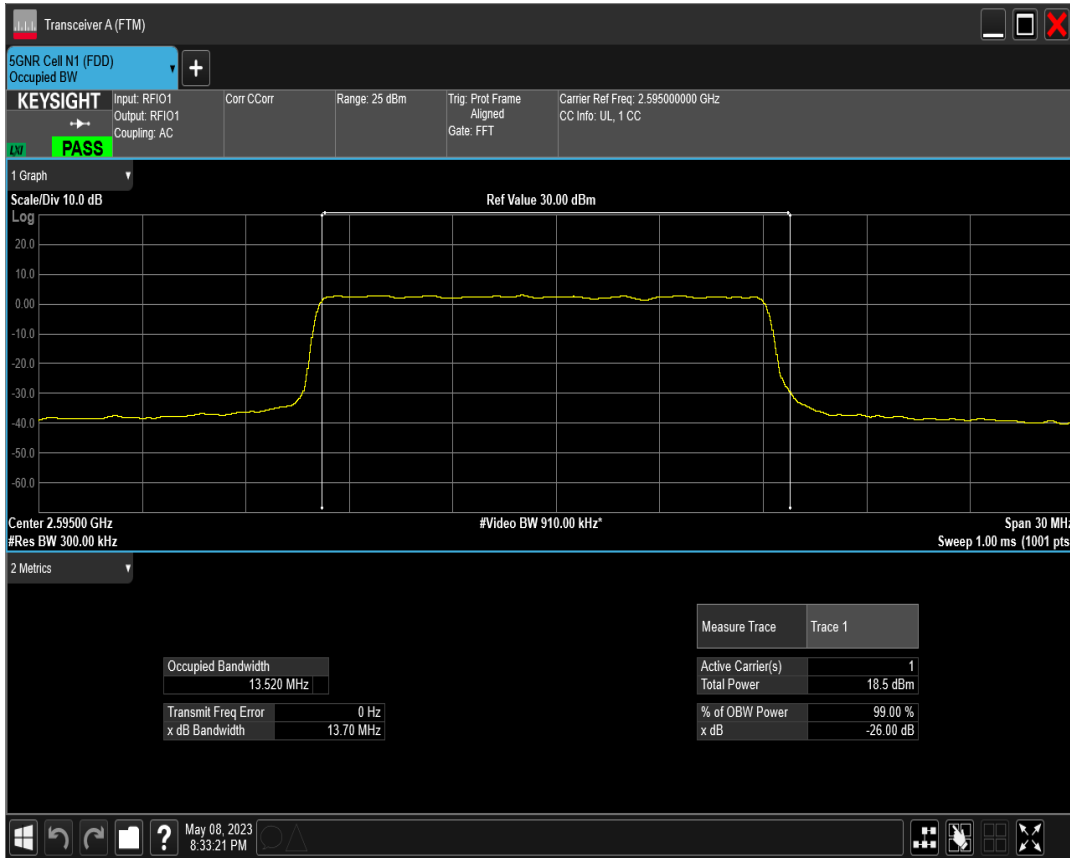
n38 SCS=30kHz CP_QPSK BW=15MHz Channel=519000 RB=38@0
