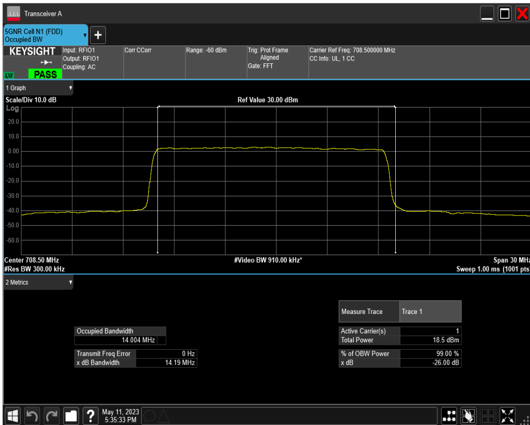
n12 SCS=15kHz CP_QPSK BW=15MHz Channel=141700 RB=79@0
