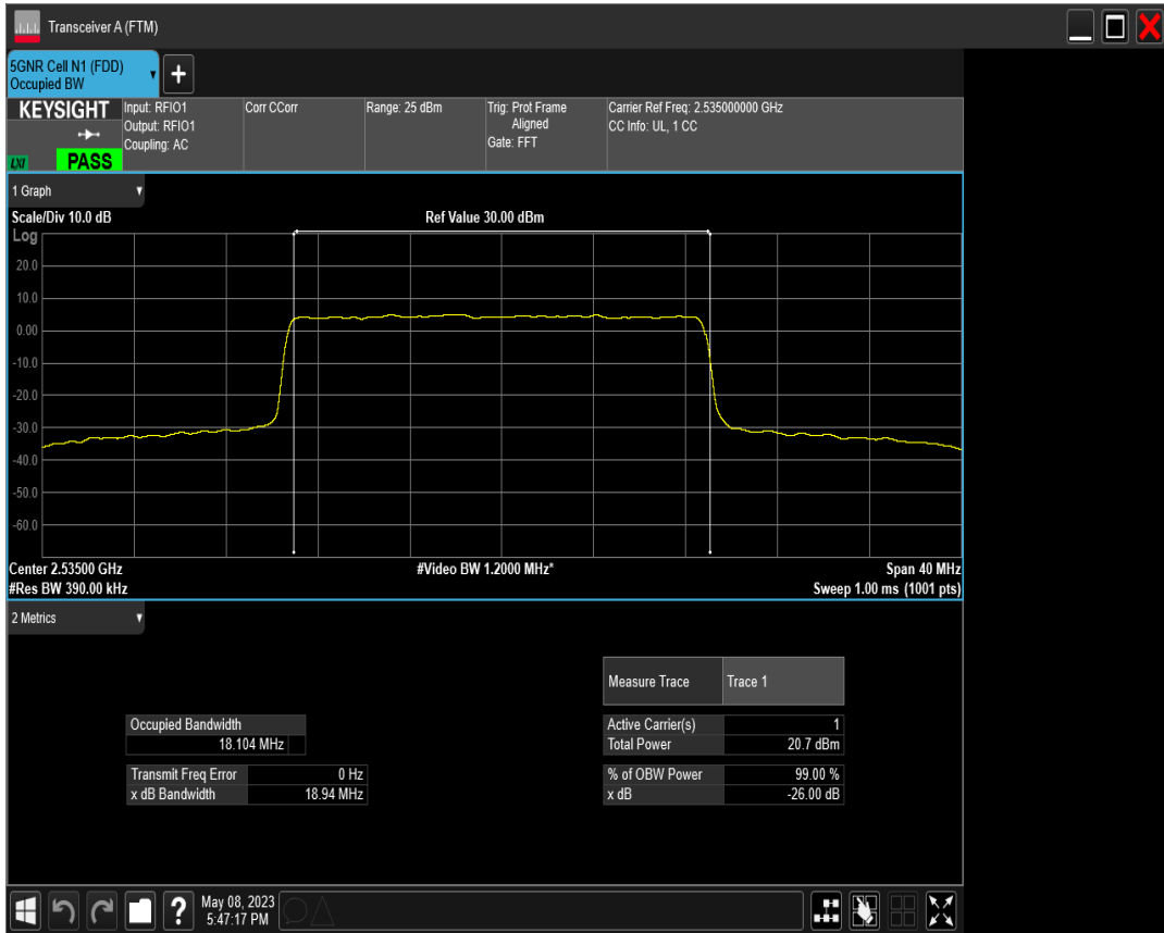
n7 SCS=30kHz DFT_QAM256 BW=20MHz Channel=507000 RB=50@0
