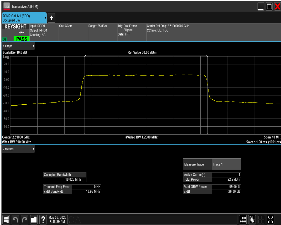
n7 SCS=30kHz DFT_QAM16 BW=20MHz Channel=502000 RB=50@0
