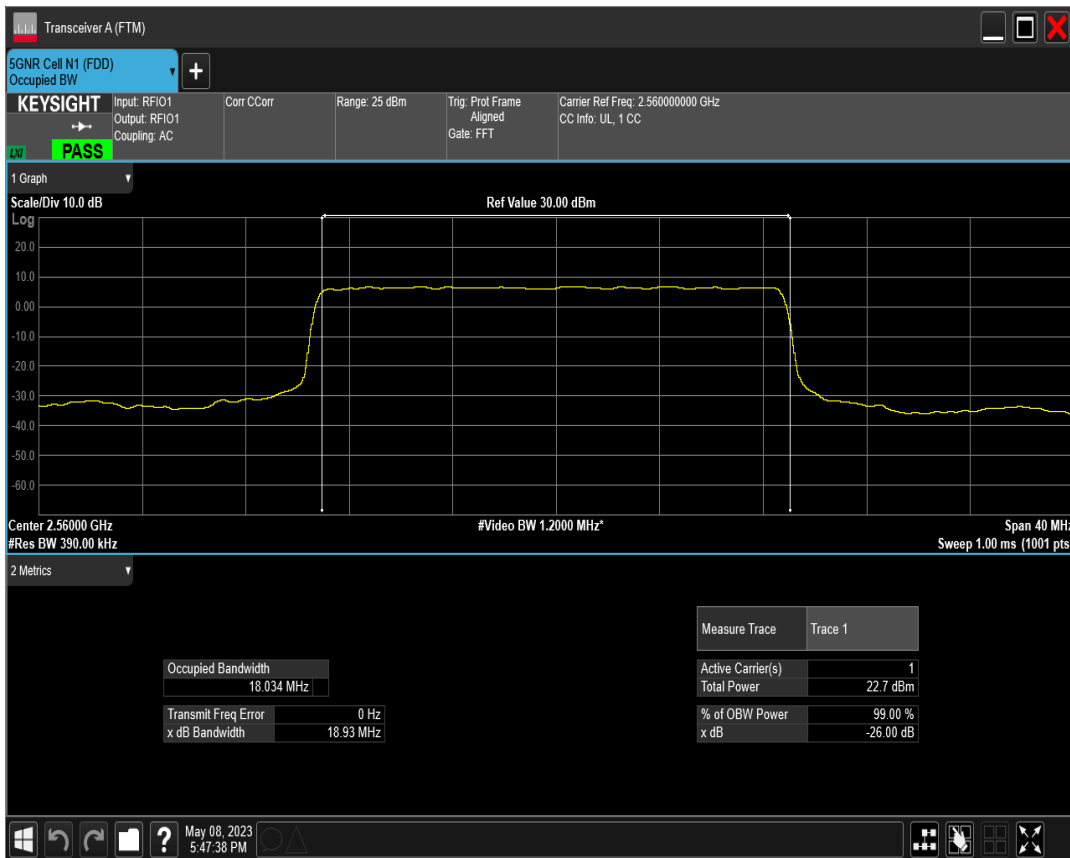
n7 SCS=30kHz DFT_QPSK BW=20MHz Channel=512000 RB=50@0
