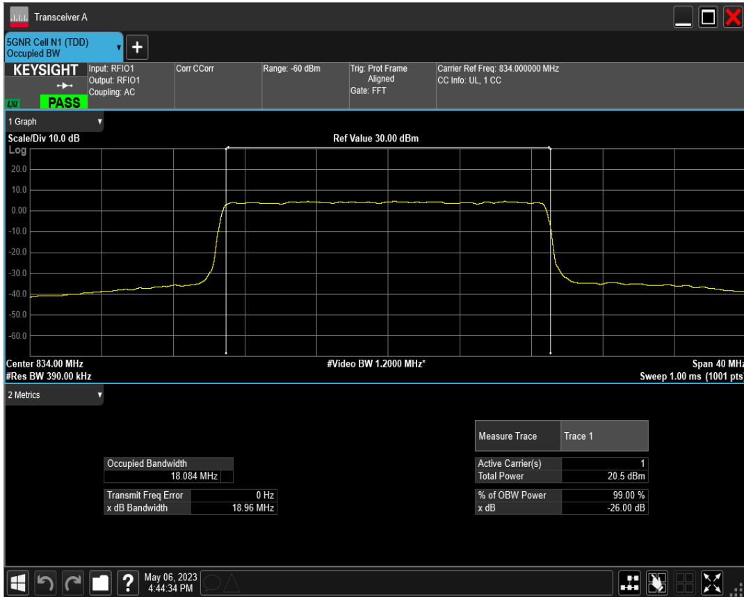
n5 SCS=30kHz DFT_QAM256 BW=20MHz Channel=166800 RB=50@0
