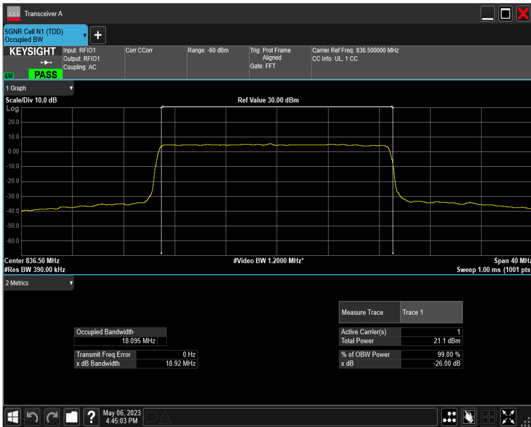
n5 SCS=30kHz DFT_QAM64 BW=20MHz Channel=167300 RB=50@0
