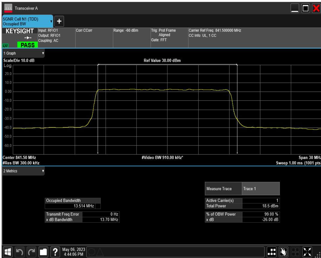
n5 SCS=30kHz CP_QPSK BW=15MHz Channel=168300 RB=38@0
