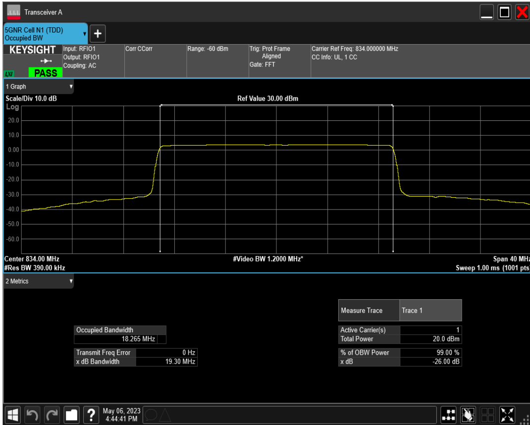
n5 SCS=30kHz DFT_BPSK BW=20MHz Channel=167300 RB=50@0
