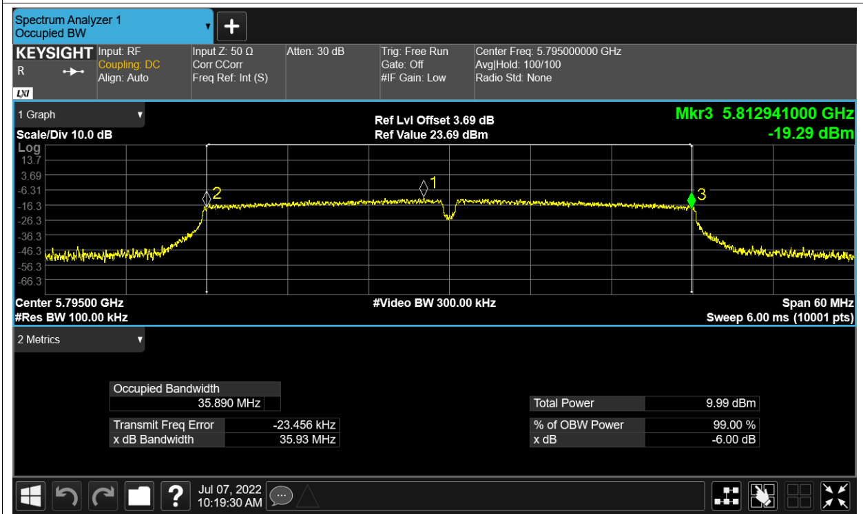
-6dB Bandwidth NVNT n40 5795MHz Ant1
