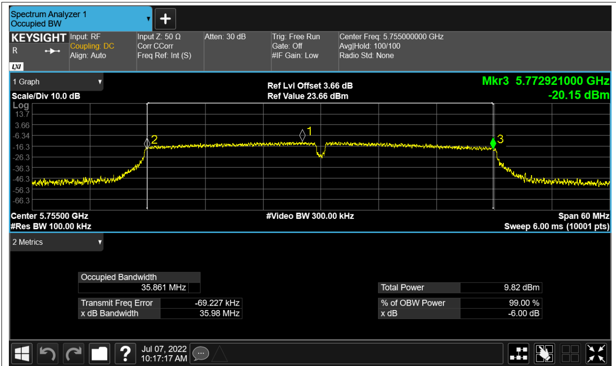
-6dB Bandwidth NVNT n40 5795MHz Ant1
