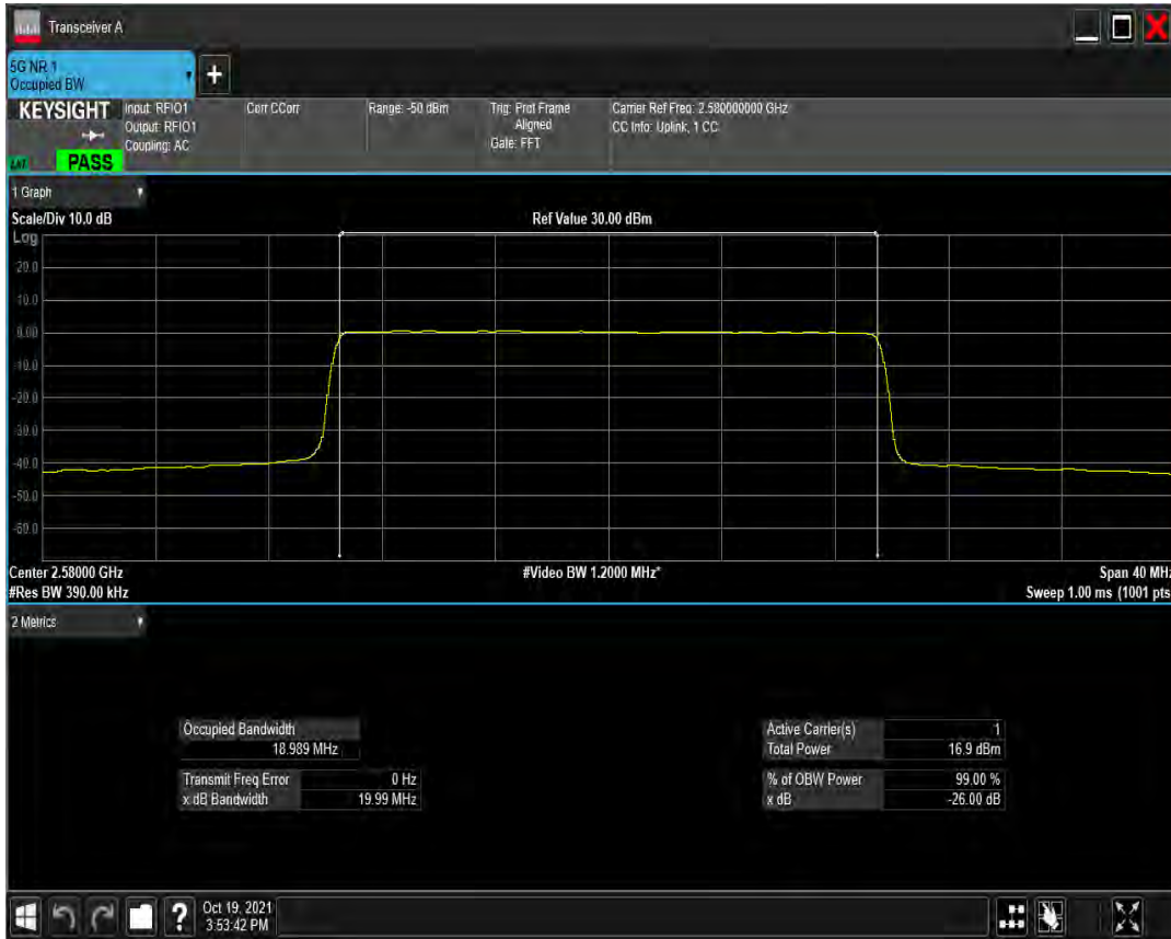
n38 SCS=15kHz DFT_BPSK BW=20MHz Channel=522000 RB=100@0
