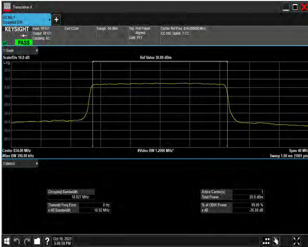
n5 SCS=30kHz DFT_QAM256 BW=20MHz Channel=166800 RB=50@0
