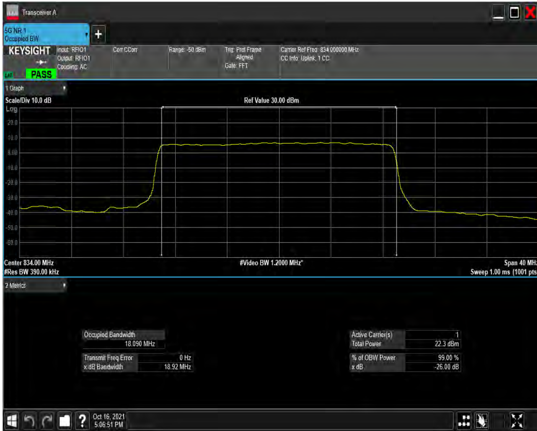
n5 SCS=30kHz DFT_QPSK BW=20MHz Channel=166800 RB=50@0
