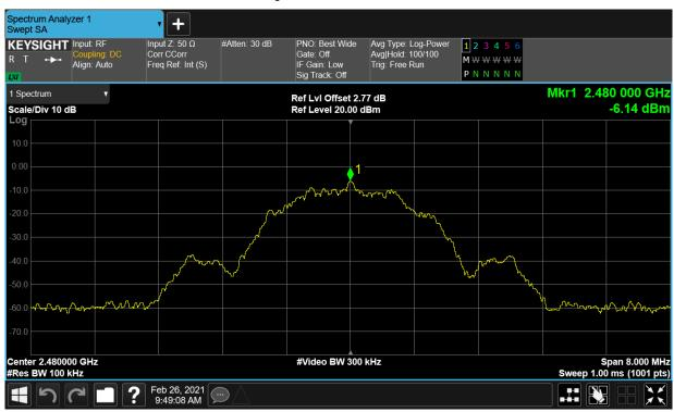
Band Edge NVNT BLE 2480MHz Ant1 Emission
