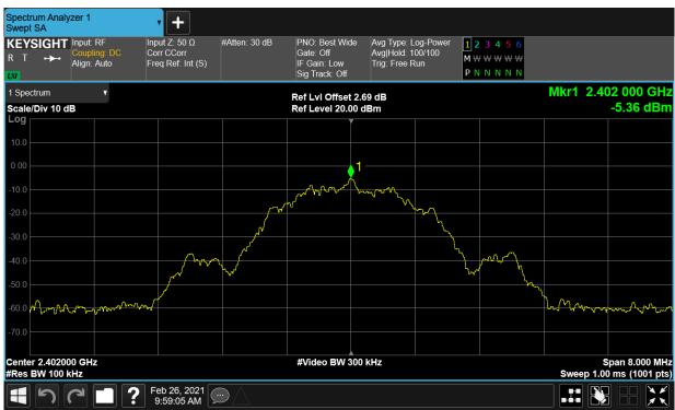
Band Edge NVNT BLE 2402MHz Ant1 Emission
