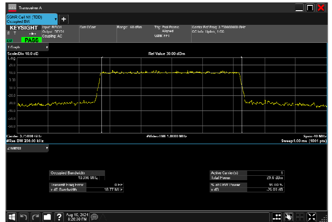
n78_3_20MHz_30kHz_3750MHz_DFT-s-OFDM 16 QAM_RB50@0 18.098MHz
