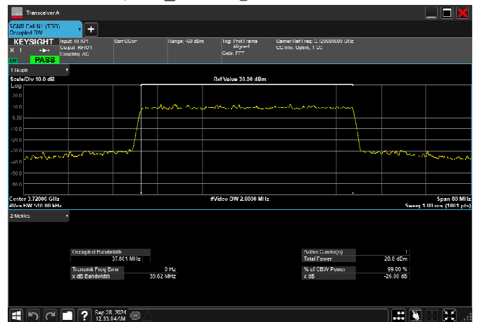
n78_3_40MHz_30kHz_3720MHz_CP-OFDM QPSK_RB106@0 37.801MHz
