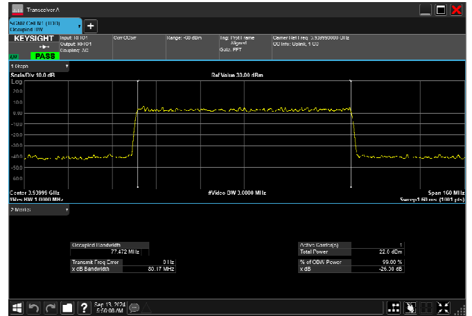
n77_3_90MHz_30kHz_3745MHz_DFT-s-OFDM \pi/2 BPSK_RB243@0 86.567MHz
