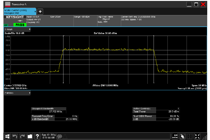
n77_1_40MHz_30kHz_3470MHz_DFT-s-OFDM \pi/2 BPSK_RB100@0 37.488MHz
