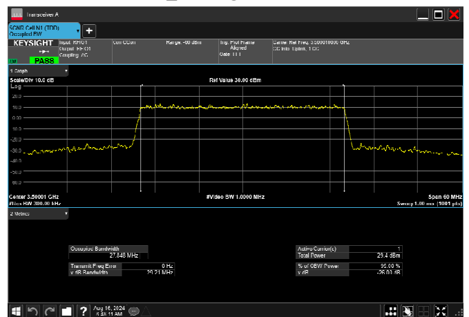
n78_1_30MHz_30kHz_3500MHz_CP-OFDM QPSK_RB78@0 27.848MHz
