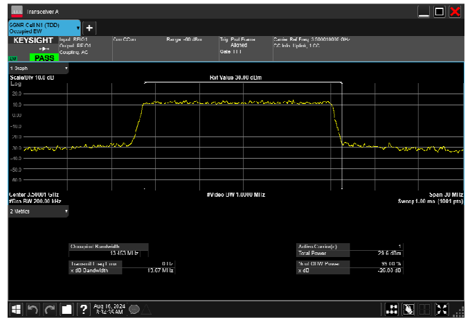
n78_1_15MHz_30kHz_3500MHz_CP-OFDM QPSK_RB38@0 13.567MHz
