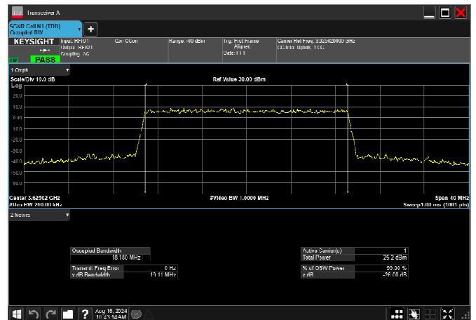
n78_2_20MHz_30kHz_3625MHz_CP-OFDM 256 QAM_RB51@0 18.180MHz
