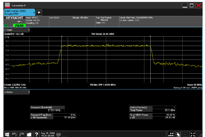
n78_2_30MHz_30kHz_3625MHz_CP-OFDM QPSK_RB78@0 27.851MHz
