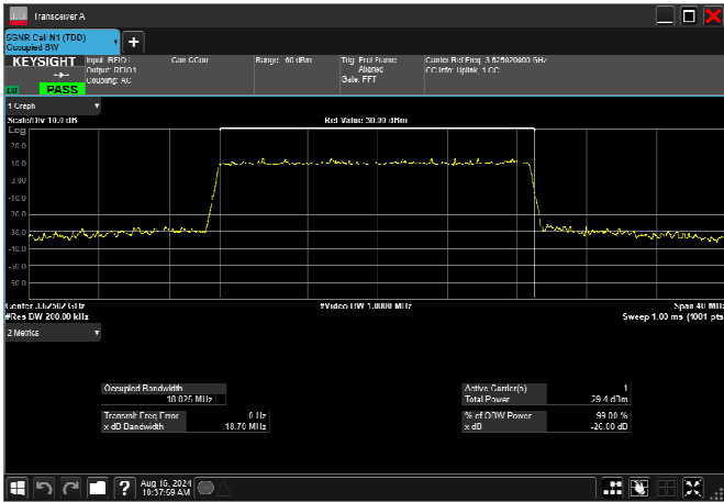
n78_2_20MHz_30kHz_3625MHz_CP-OFDM QPSK_RB51@0 18.168MHz
