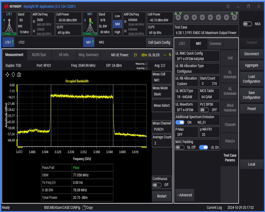
n78 SCS=30kHz DFT_QAM64 BW=20MHz Channel=636666 RB=50@0
