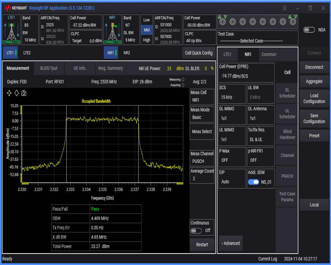
n7 SCS=15kHz DFT_QPSK BW=10MHz Channel=507000 RB=50@0
