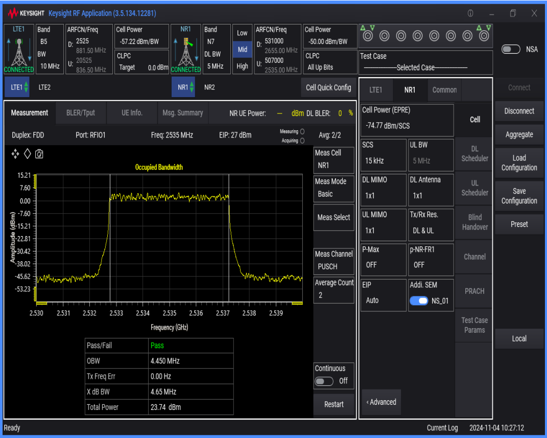
n7 SCS=15kHz DFT_BPSK BW=10MHz Channel=507000 RB=50@0
