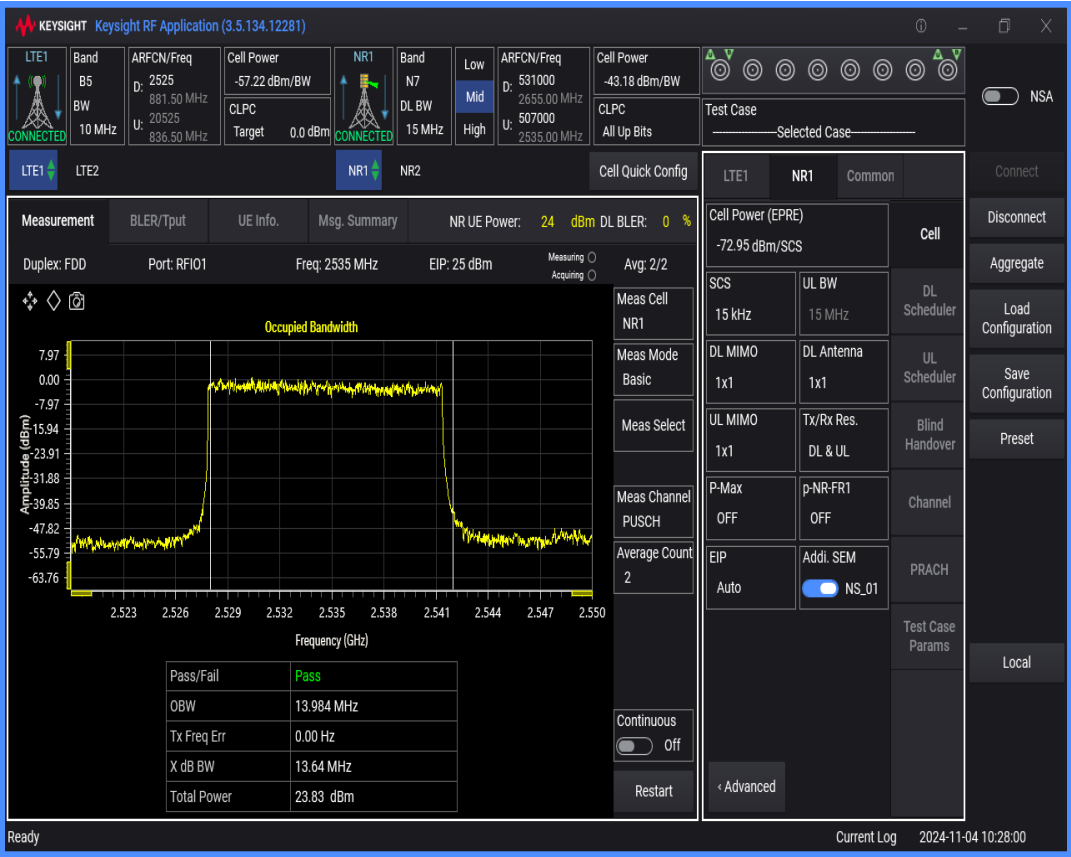
n7 SCS=15kHz DFT_BPSK BW=20MHz Channel=507000 RB=100@0
